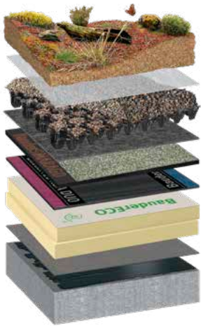
BauderECO F 0°-Dach mit Gründach-Aufbau
